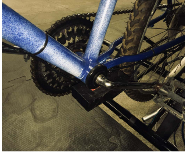
Figure 1. Mouse inserido de forma a captar a movimentação do pedal da bicicleta.
