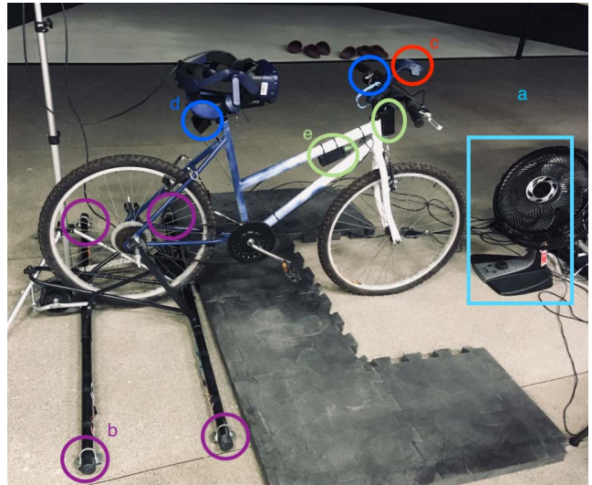
Figure 2. Bicicleta disposta no dispositivo de uso onde podemos observar os sensores: “a” indicando o ventilador usado para sensação de velocidade, “b” indicando as células de carga que medem a intensidade com que o usuário projeta seu corpo para os lados da bicicleta, “c” indicando o controle do HMD para obter a direção, “d” indicando os motores de 1.5V que fornecem a resposta háptica e “e” indicando os potenciômetros que captam a intensidade da frenagem.
