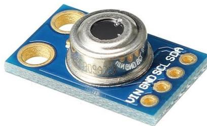
Figura 10 – Sensor de temperatura infravermelho MLX90614
