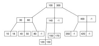
Como ficará a árvore se realizarmos cada uma das operações a seguir, seguindo o algoritmo de inserção para árvores B visto na disciplina? Cada uma das operações deve ser realizada sobre a árvore original. Desenhe (na folha a parte) a nova árvore para cada caso.
