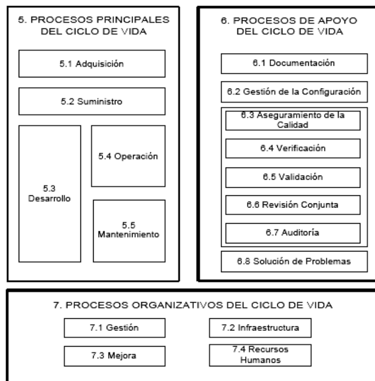
Figura N° 3: Estructura NTP para procesos del ciclo de vida del software Fuente: [03]
