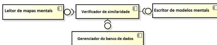
**Fig. 2.** Diagrama de componentes da ferramenta proposta
